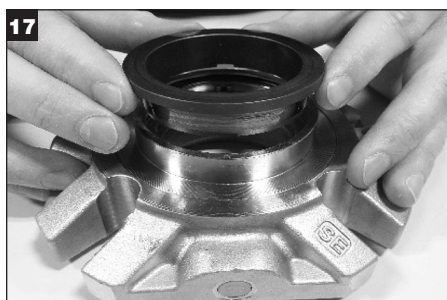
17 Remova e descarte o anel de selo estacionário interno da sobreposta.
