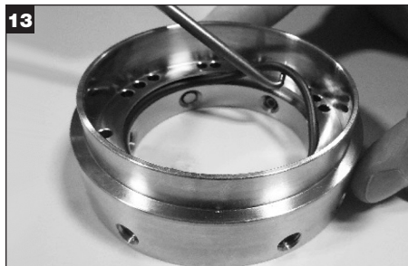
13 Remova e descarte o O-ring (Y) do anel de trava da luva.
